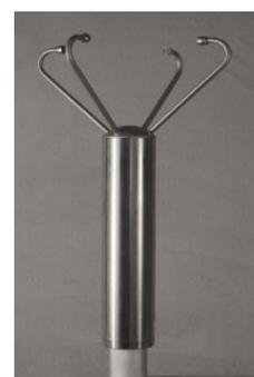
Os Anemômetros Ultrassônicos, como os USA-2, encontram aplicação nas instalações de turbinas eólicas e como um substituto para uma instalação padrão de rotor de copo e seta indicadora em medições de torre. O Anemômetro ultrassônico pode ser aquecido porque não há peças em rotação. METEK oferece também uma solução “serviço
